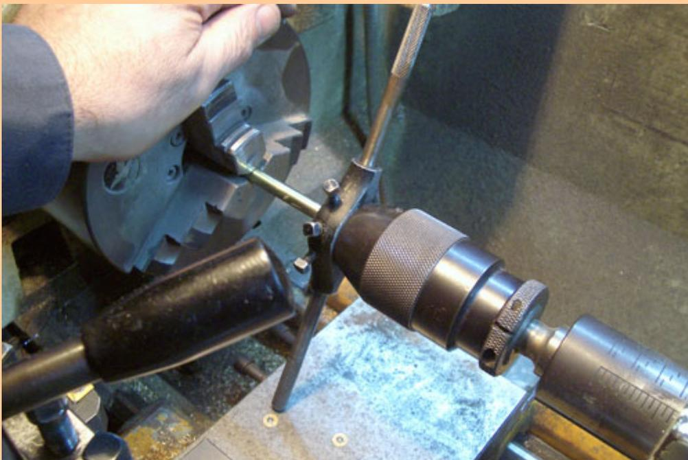
Los machos, son una especie de tornillos con tres rebajes longitudinales para el desalijo de la viruta producida al cortar. Disponen de un mango acabado en un cuadradillo para fijar el giramachos. Al igual que las terrajas, están fabricados en aceros especiales para herramientas de corte y debidamente templados.
