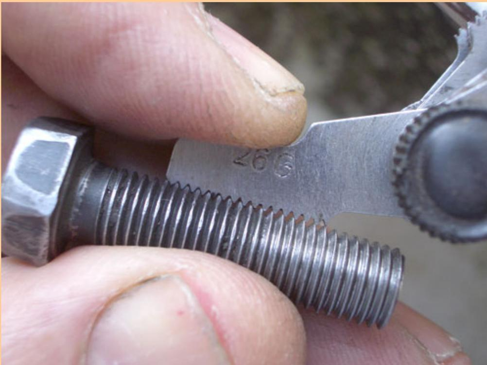
El otro, mediante procedimiento similar, constatamos que la galga que encaja es la de 1,25. Entonces tenemos dos tornillos métricos. Uno en métrica 8x1,00 (fina) y el otro 8x1,25 (normal).
